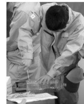
ペットボトルの底から1cm程度上の両サイドにキリや目打ちで穴を開け、空いた穴に、はさみの先を入れ、5mm程度まで穴を大きくするとよい。
